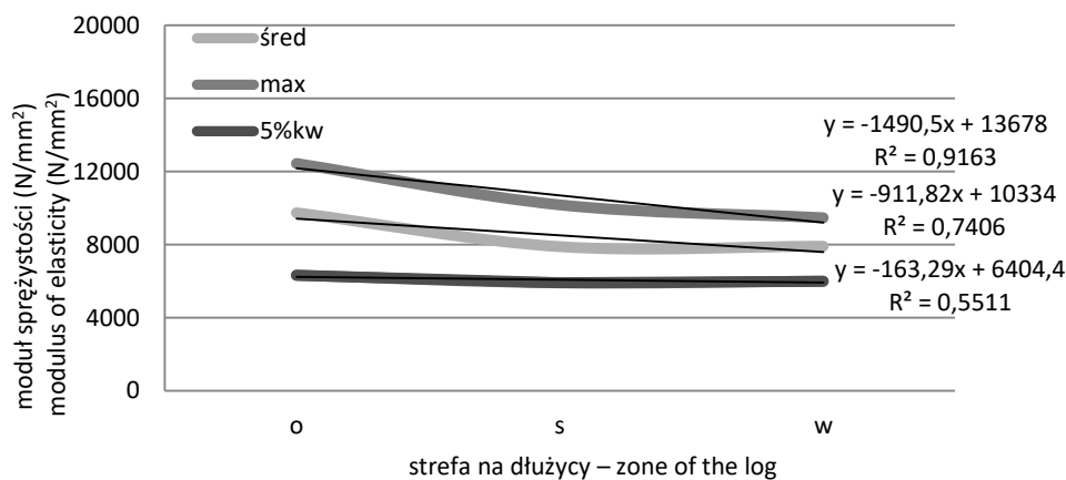
Ryc. 37. Moduł sprężystości dla próbek promieniowych – ława Fig. 37. Modulus of elasticity for radial samples – ława
