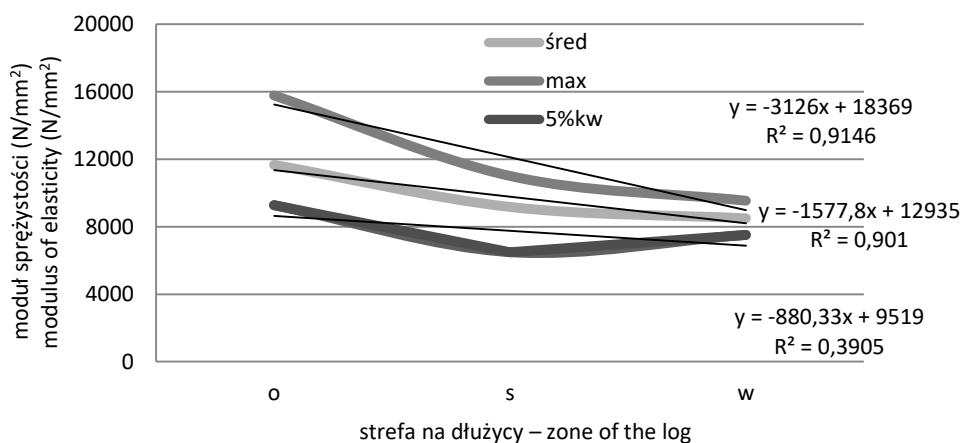
Ryc. 31. Moduł sprężystości dla próbek promieniowych – Borne Sulinowo
