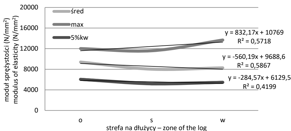
Ryc. 28. Moduł sprężystości dla próbek promieniowych – Człuchów Fig. 28. Modulus of elasticity for radial samples – Człuchów
