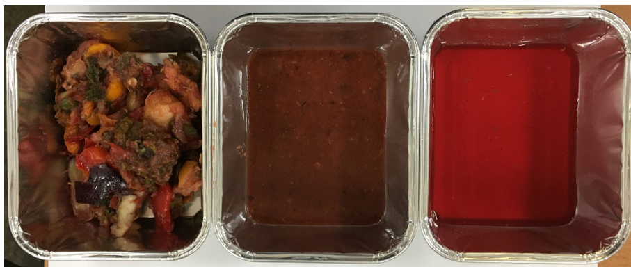
Ryc. 12. Frakcje ciekłe uzyskane przez grawitacyjne sączenie, wyciskanie oraz frakcja stała odpadów (fot. W. Czekala)
