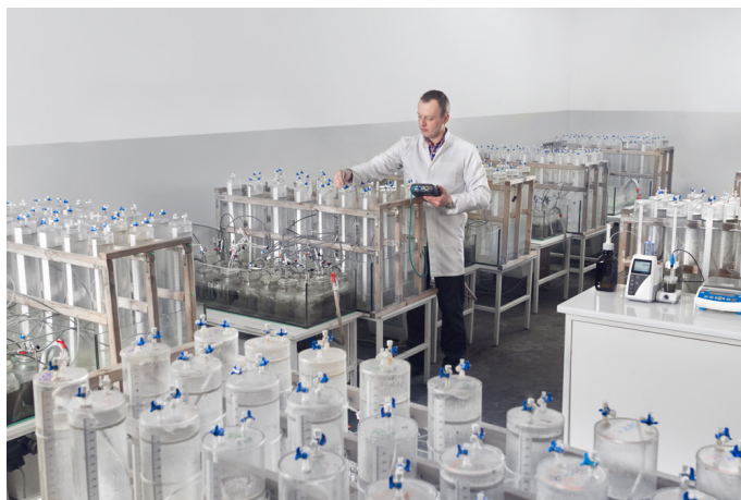
Ryc. 17. Stanowiska wykorzystywane do badania wydajności biogazowej i metanowej substratów (Materiały promocyjne Instytutu Inżynierii Biosystemów)
