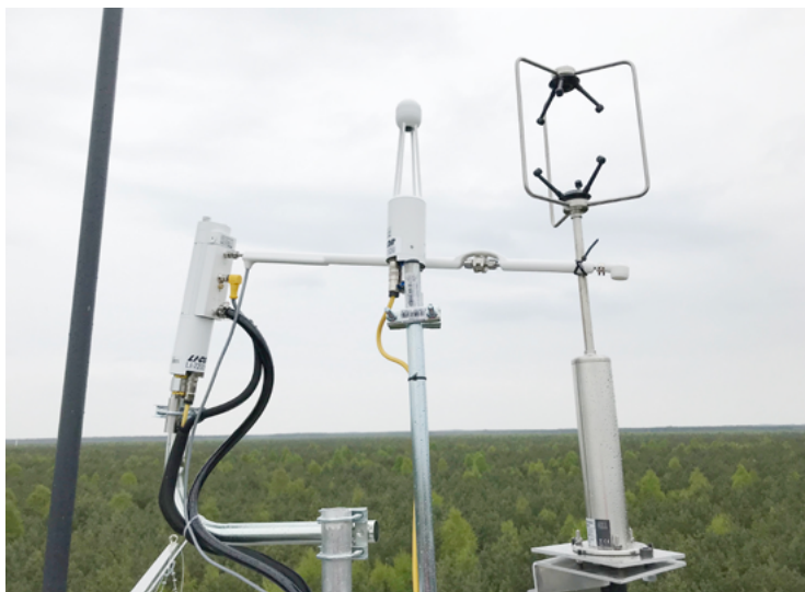
Rys. 16. Przykład systemu kowariancji wirów na stacji Mężyk 1, zainstalowanego przez autora niniejszej pracy. Dzięki systemowi możliwe są pomiary strumieni: ciepła jawnego ( S ), ciepła utajonego ( \lambda E ) i \text{CO}_2 ( F_c ). Od lewej: analizator LI-7200DS z przymkniętą ścieżką pomiarową (CP), analizator LI-7500RS z otwartą ścieżką pomiarową (OP), anemometr WindMaster Pro (fot. Marek Urbaniak)
