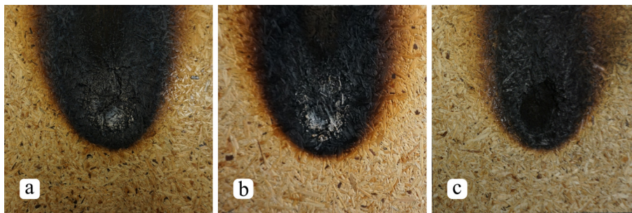
Ryc. 17. Płyty wiórowe zaklejone żywicą UF po próbach palności: a – bez nano-SiO 2 , b – z nano-SiO 2 + 3 cz.w. APTES, c – z nano-SiO 2 + 5 cz.w. APTES
