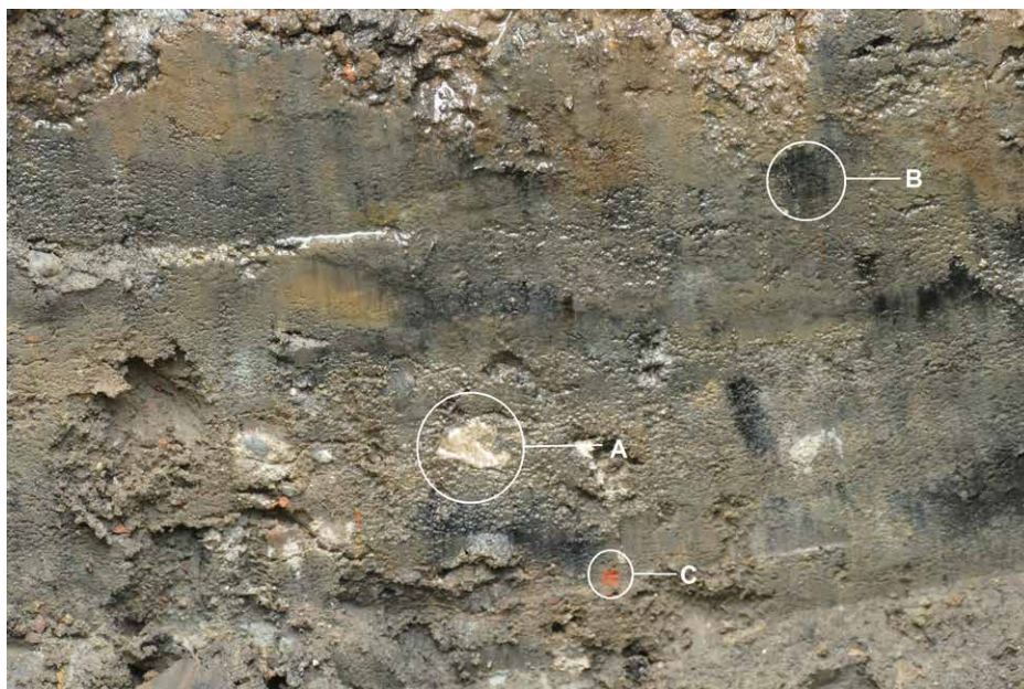
Ryc. 5. Typowe składniki profili glebowych w masie oglejonego zwięzłego osadu o ciężkim składzie granulometrycznym (z profilu nr 16): A – okrusz skały wapiennej, B – fragment żużli, C – fragment ceramiki budowlanej
